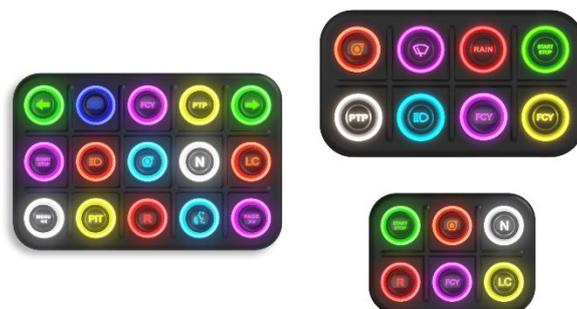
**Keypad versione Open** è la nuova gamma di espansioni compatte basate sul CAN bus. È disponibile in diverse versioni a seconda del numero di tasti il cui stato viene trasmesso via CAN bus. Sia i tasti che i messaggi CAN sono completamente configurabili attraverso la connessione USB utilizzando il software AiM RaceStudio 3.
